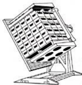
Samostojeci izvrtnac tereta nezavisni transfer palete na paletu.
