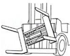
Izvrtnac tereta - Load Inverter Lak prenos sa palete na paletu.
