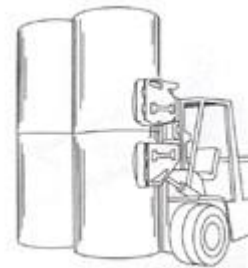
Cetvoropaketna stipaljka za rolne papira Rad sa 1, 2 ili 4 rolne sa specijalno dizajniranim papucicama na rukama.
