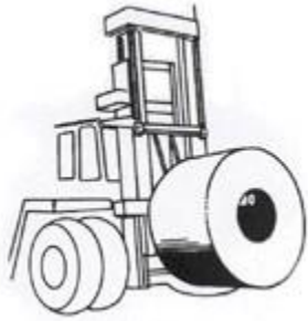
Nosac koturova Za različite velicine koturova.
